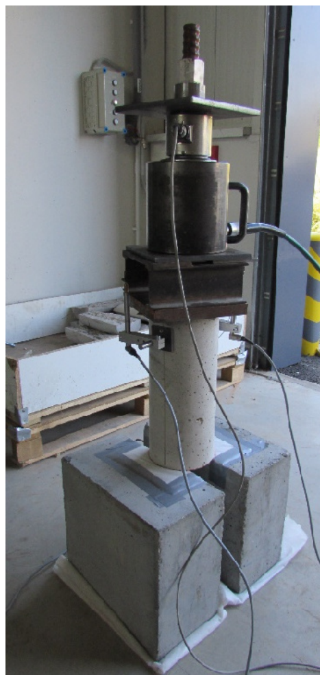
Pull-out test kotevní délky výztuže (na krychli a na válci)
