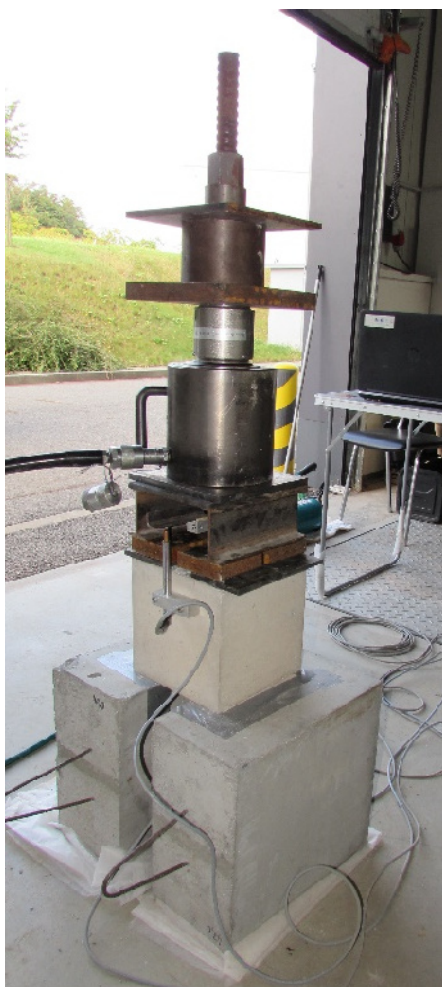
Pull-out test kotevní délky výztuže (na krychli a na válci)
