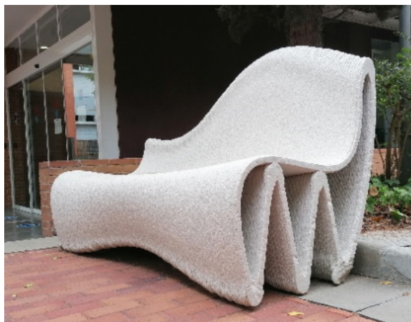
Betonová lavice vyrobená 3D tiskem
