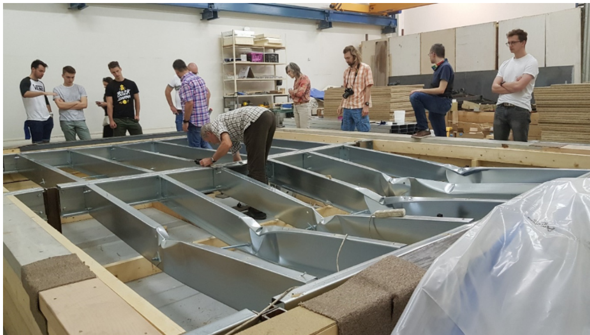
Experimentální ověření jedné z variant sestavy stropní konstrukce – ilustrace uspořádání sestavy a porušení po dosažení mezní únosnosti
