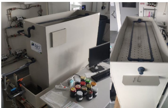
Písková filtrační jednotka (vlevo) a pohled na roznášecí desku (vpravo)
