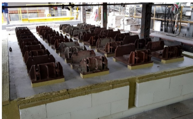
Zkušební tělesa osazená v požární peci (obr. nahoře) a zatížení (obr. dole)
