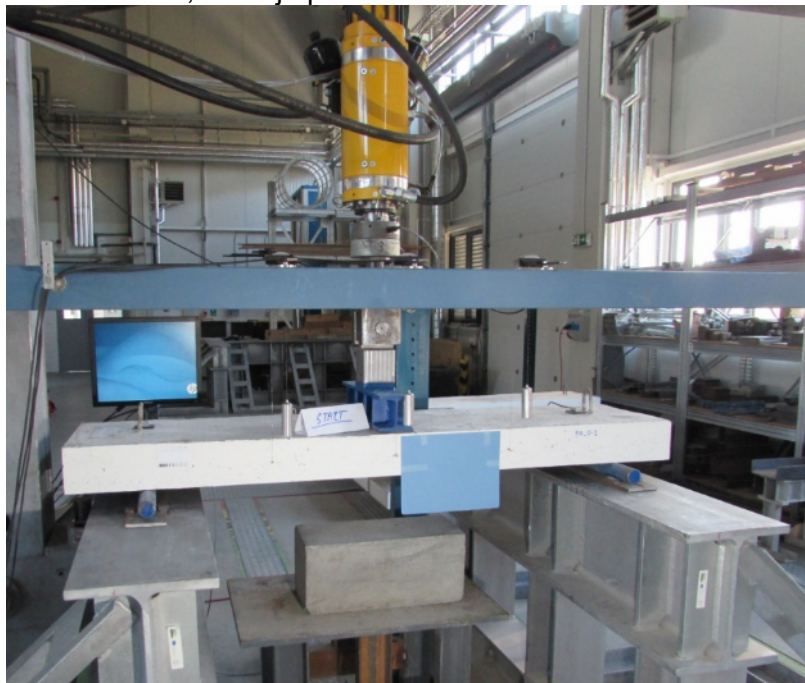
Zatěžovací zkouška panelů v tříbodovém ohybu
