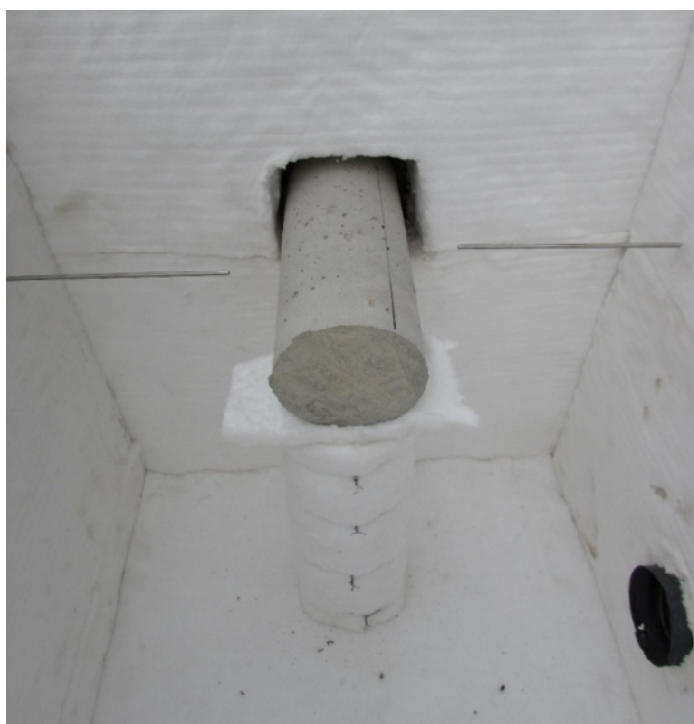
Umístění vzorku uvnitř spalovací komory požární pece
