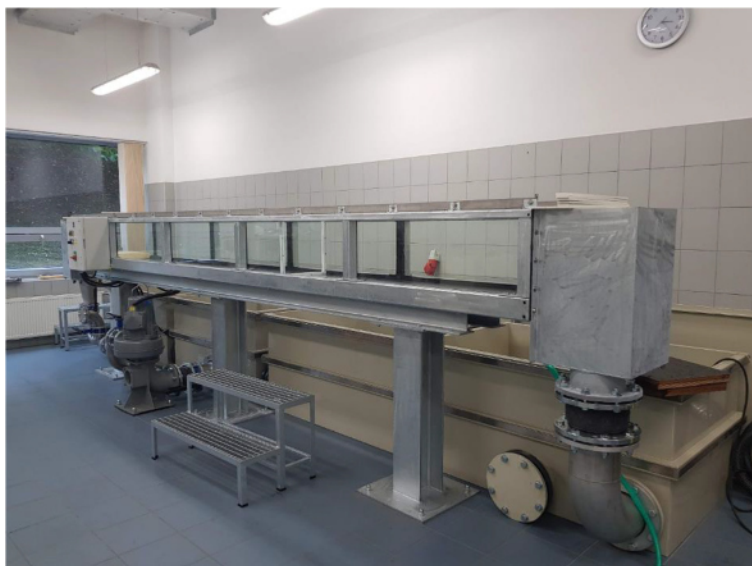
Celkový protiproudňý pohled na hydraulický okruh s měřným žlabem
