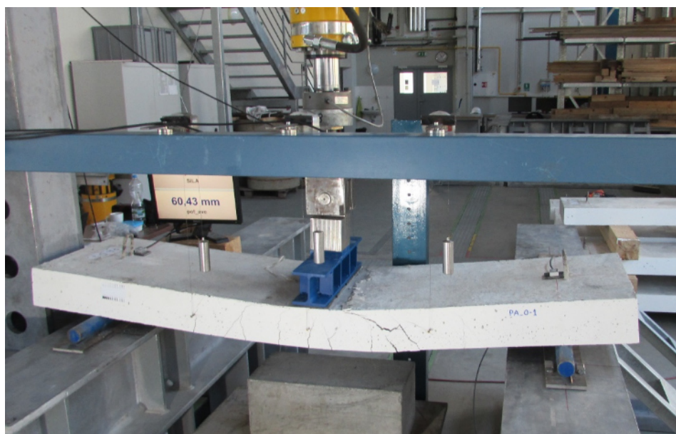
Porušení panelu s GFRP výztuží při rozpětí 1,4 m
