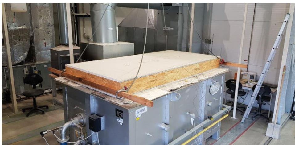
Obr. č. 4: Zkoušení požární odolnosti skladby stěnového prvku dřevostavby s integrovanou tepelně-izolační vrstvou uvnitř prvku.
