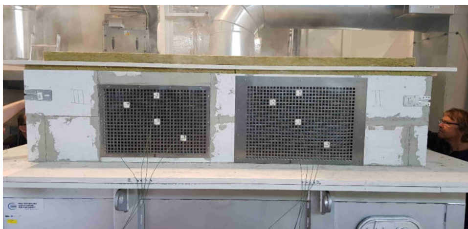
Obr. č. 5: Zkoušení požární odolnosti protipožárních větracích mřížek, ve kterých jsou integrovány segmenty, které při zvýšení teploty expandují a zabraňují tak dalšímu šíření plamene skrze větrací mřížky.
