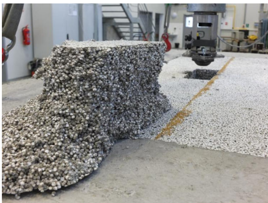
Obr. č. 2 Vzorek polystyrenu betonu po zkoušce únosnosti výplně ž.b. panelu (spolupráce s firmou 3isolet)
