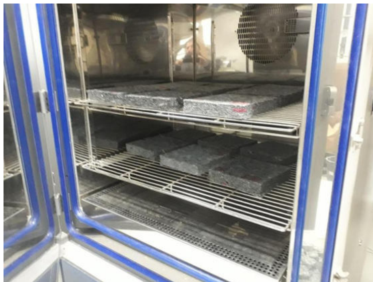
Obr. č. 3 Vzorky textilních izolací s hydrofobizací v klimatické komoře (vývoj nových materiálů s firmou Retex)
