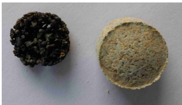
Obr. č. 8: Detailní pohled na vzorky cementotřískové desky po zkoušce (vlevo) a před zkouškou (vpravo) při stanovení spalného tepla, která je součástí klasifikačních zkoušek reakce na oheň.
