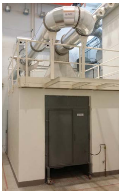
Obr. č. 11: Pec pro zkoušení vystavení tepelnému účinku jednotlivého hořícího předmětu (SBI test)
