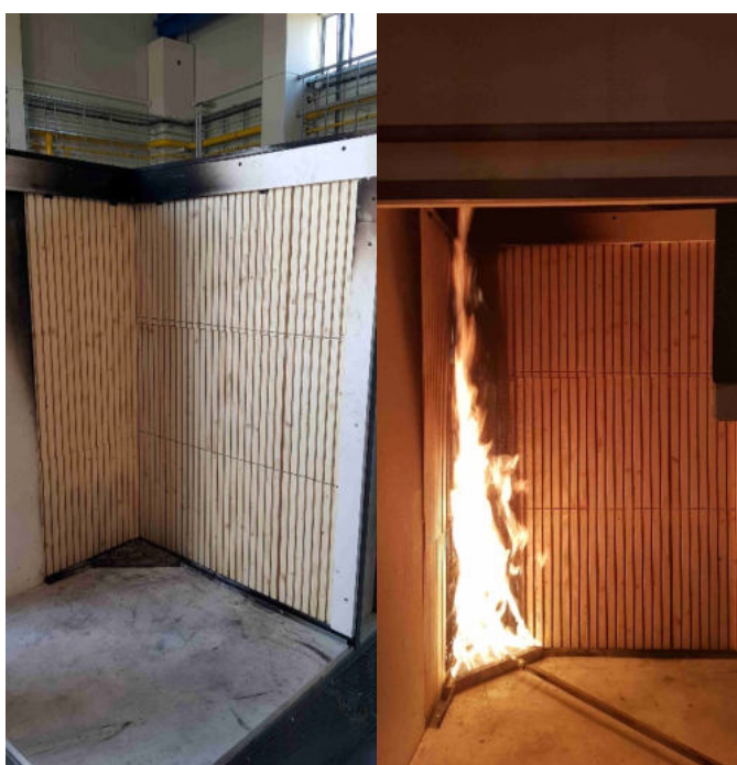
Obr. č. 7: Dřevěné akustické panely před zkouškou a při zkoušce stanovení reakce na oheň, konkrétně při působení jednotlivého hořícího předmětu. Oba pohledy jsou na zkušební vzorek instalovaný na vozík zkušebního zařízení, který je zavážen do zkušební komory.
