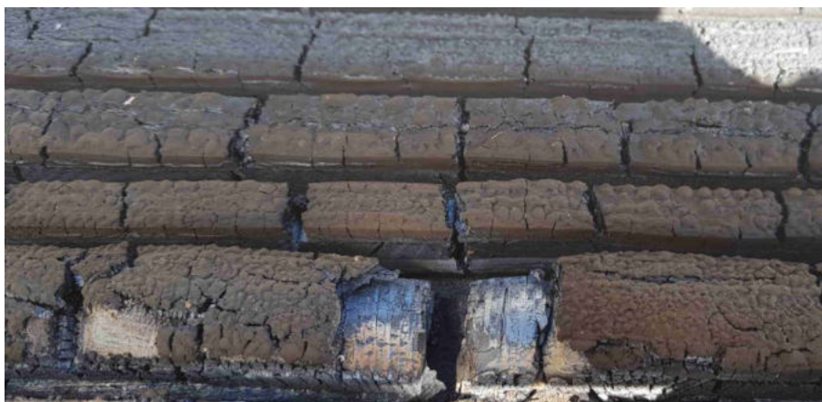
Obr. č. 6: Pohled na vzorek dřevěného akustického panelu po zkoušce, s expandovaným protipožárním nátěrem na povrchu.
