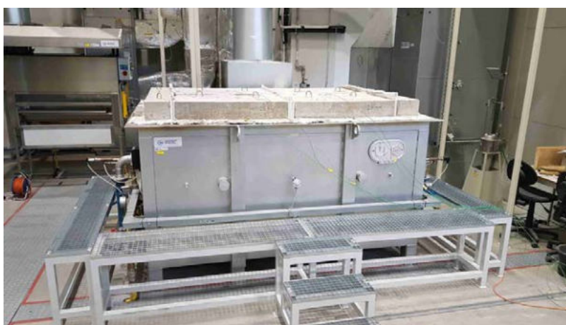
Obr. č. 10: Zkoušení požární odolnosti termoizolačního nosníku v železobetonové desce a sledování vývoje teplot uvnitř prvku po dobu 120 minut při působení vysokých teplot (do 1 100 °C) – pohled na uložený vzorek při zkoušce
