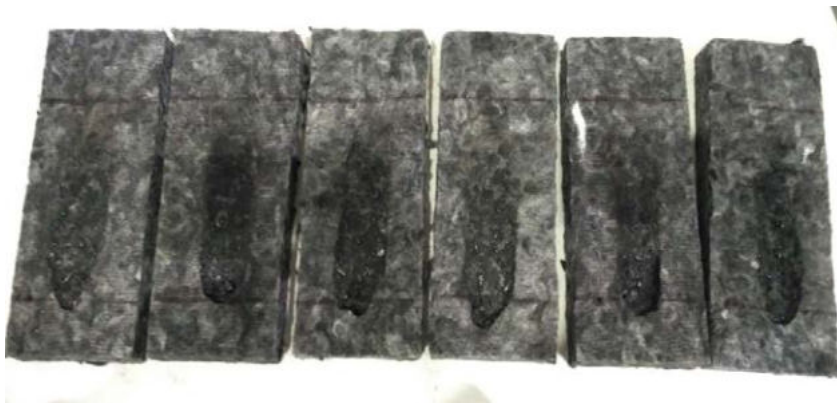
Obr. č. 9: Vzorky tepelně-izolačního materiálu po zkoušení reakce na oheň - zápalnost stavebních výrobků vystavených přímému působení plamene - malým zdrojem plamene.
